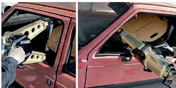
5. **Técnica del pellizco.** Con el Separador pinzamos los bordes de las puertas para posteriormente moverlo para crear espacio.
