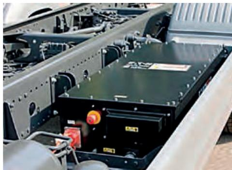
Las baterías AV suelen disponer de interruptor manual de servicio o "Plug Service", que anula el intercambio de energía de la batería de alto voltaje hacia el resto del vehículo. Su colocación y tipo de mecanismo es también muy variable. Ejemplos:
