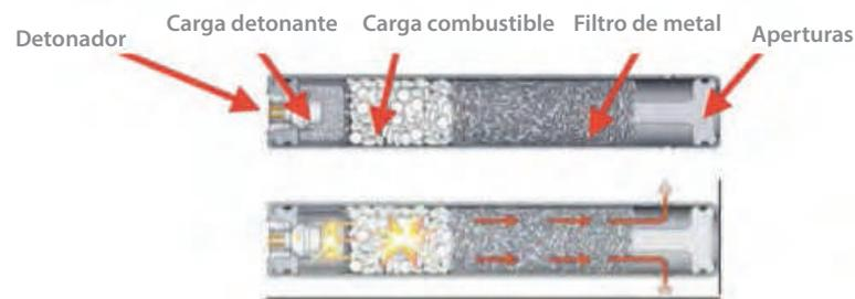
Cuando el compartimento de combustible recibe la señal eléctrica de la unidad de control se produce un aumento de presión perforando a través de una punta metálica el compartimento de gas saliendo por el filtro y dirigido por una conducción metálica hasta la bolsa de aire.
