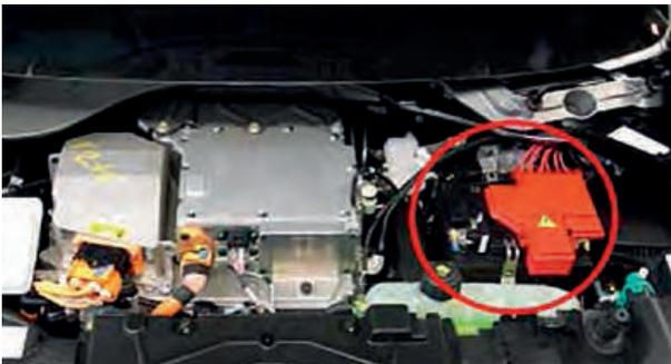
Batería auxiliar Renault ZOE eléctrico
