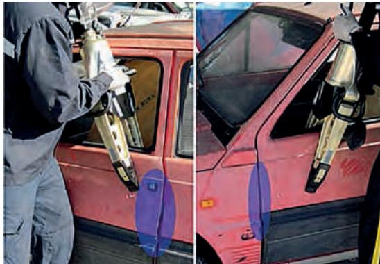
**4. Separar marco.** Apoyar el separador en el marco de la ventanilla a unos 10 cm del pilar B. Abrir la herramienta y colocar la punta del separador de forma que intente abrir hueco separando la puerta. Con esta maniobra conseguimos la deformación de la puerta y la creación de espacio, además de su posible apertura.
