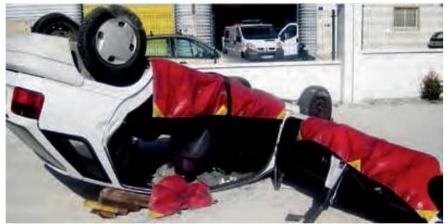
**4. Abatimiento de puerta + pilar B con herramienta hidráulica.**
