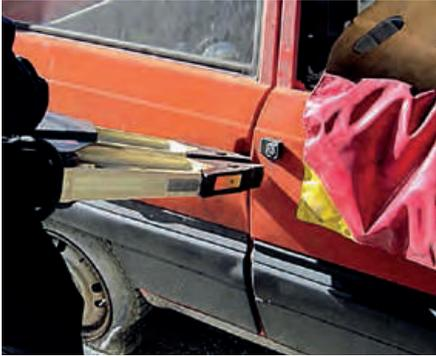
6. Con **palanca de uña**. Introducir la parte curva en la hendidura de la puerta realizando un movimiento de vaivén con la herramienta para proceder a crear el espacio.
