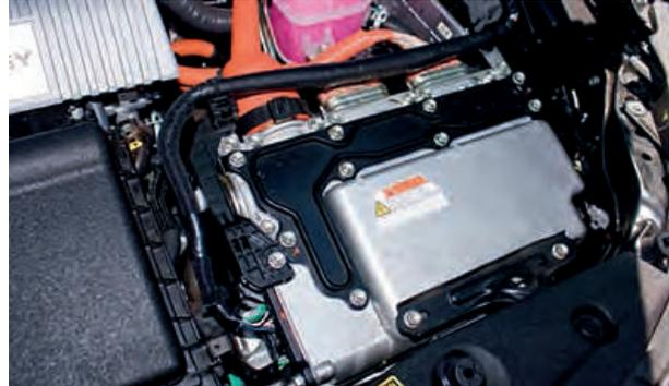
Cableado naranja conectado al inversor/convertidor
