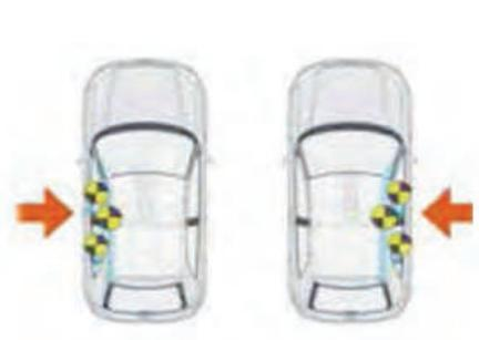
En la mayoría de los sistemas de airbag, la activación del detonador no depende únicamente del tiempo transcurrido desde el impacto, si no que interviene una serie de factores como son la velocidad del vehículo, aceleración, tipo de choque (frontal u oblicuo), etc..., y esto lleva a un proceso de gestión interna de la unidad de control donde coteja con precisión todos estos factores.
