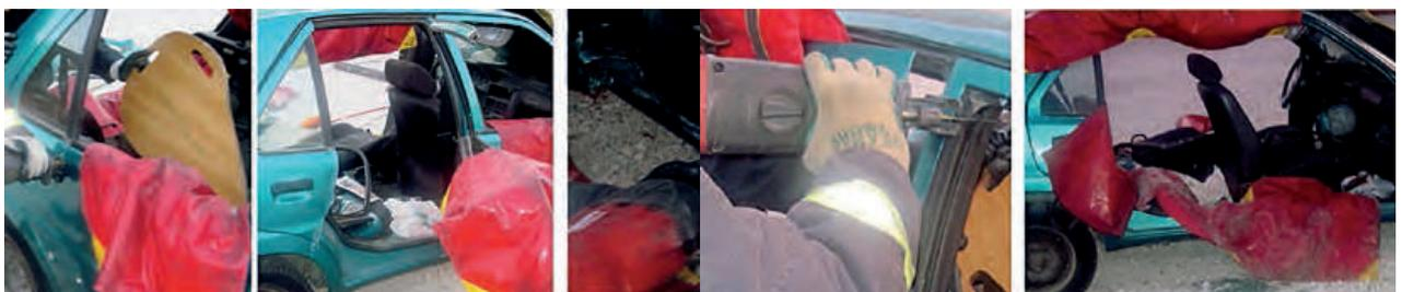
**3. Retirada de lateral con abatimiento de puerta trasera con herramientas hidráulicas.**
