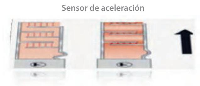
Pero este sensor es muy sensible a las radiaciones electromagnéticas, como las que radia los teléfonos móviles o las cercanías a una central eléctrica o aeropuerto por este motivo se instala el sensor mecánico de seguridad.
